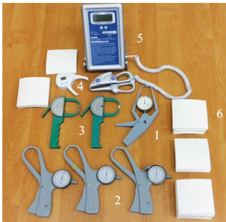
Рис. 1. Использованное оборудование и материалы. Калиперы: 1 – Вереск, 2 – GPM, 3 – Lange, 4 – FatTrack II, 5 – КЭЦ-100; 6 – «сэндвичи» из силиконовой резины различной толщины для эмуляции измерений жировых складок
